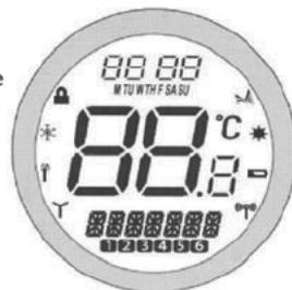
Nach 2 Sekunden wechselt der ST620 in den Betriebsmodus Raumtemperatur wird angezeigt. Das Funkuhr-Symbol blinkt.
