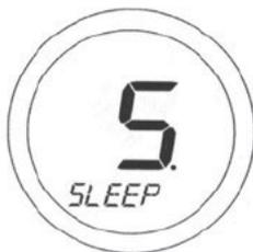
Halten Sie den Touch-Ring für eine Sekunde lang gedrückt, um die LCD-Hintergrundbeleuchtung einzuschalten. Halten Sie den Touch-Ring für 3 Sekunden lang gedrückt, um den programmierbaren Thermostat ST620 aus dem SLEEP-Modus aufwachen zu lassen und in den AUTO-Modus wechseln zu lassen.
