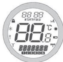
Auf dem Display wird eine Kombination aus Symbolen und alphanumerischen Informationen angezeigt. In der oberen Zeile werden die Uhrzeit und der Wochentag angezeigt, die mittlere Zeile wird zur Angabe der Raumtemperatur (in °C) verwendet und die untere Zeile dient der alphanumerischen Ausgabe von Menüs und Zustandsnachrichten. Bei den Symbolen, die um das Display herum angeordnet sind handelt es sich um Zustandsanzeigen, deren Bedeutung im Einzelnen auf der nächsten Seite erläutert wird.
