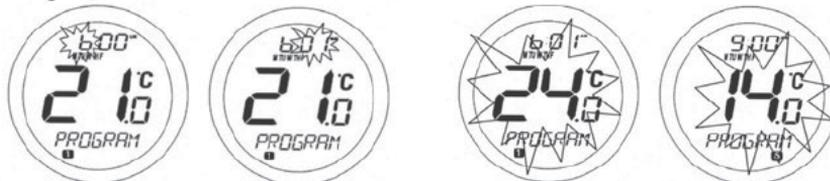
Zunächst werden die Uhrzeiteinstellungen vorgenommen. Dabei blinkt die Stundenanzeige der Uhrzeit, so dass diese leicht zu erkennen ist. Mit dem Touch-Ring können Sie die Uhrzeit auf den gewünschten Wert einstellen. Drücken Sie dann OK, um die Auswahl zu bestätigen.
