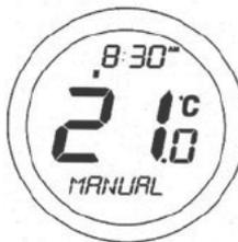
Der Modus „manuelle Steuerung“ kann jederzeit deaktiviert werden, indem die Pfeiltaste für 2 Sekunden gedrückt wird. Dadurch wechselt der ST620 wieder in den AUTO-Modus. Wenn sich der ST620 im Frostschutz-, Urlaubs- oder Servicemodus befindet, kann die Solltemperatur nicht verändert, sondern nur angezeigt werden.
