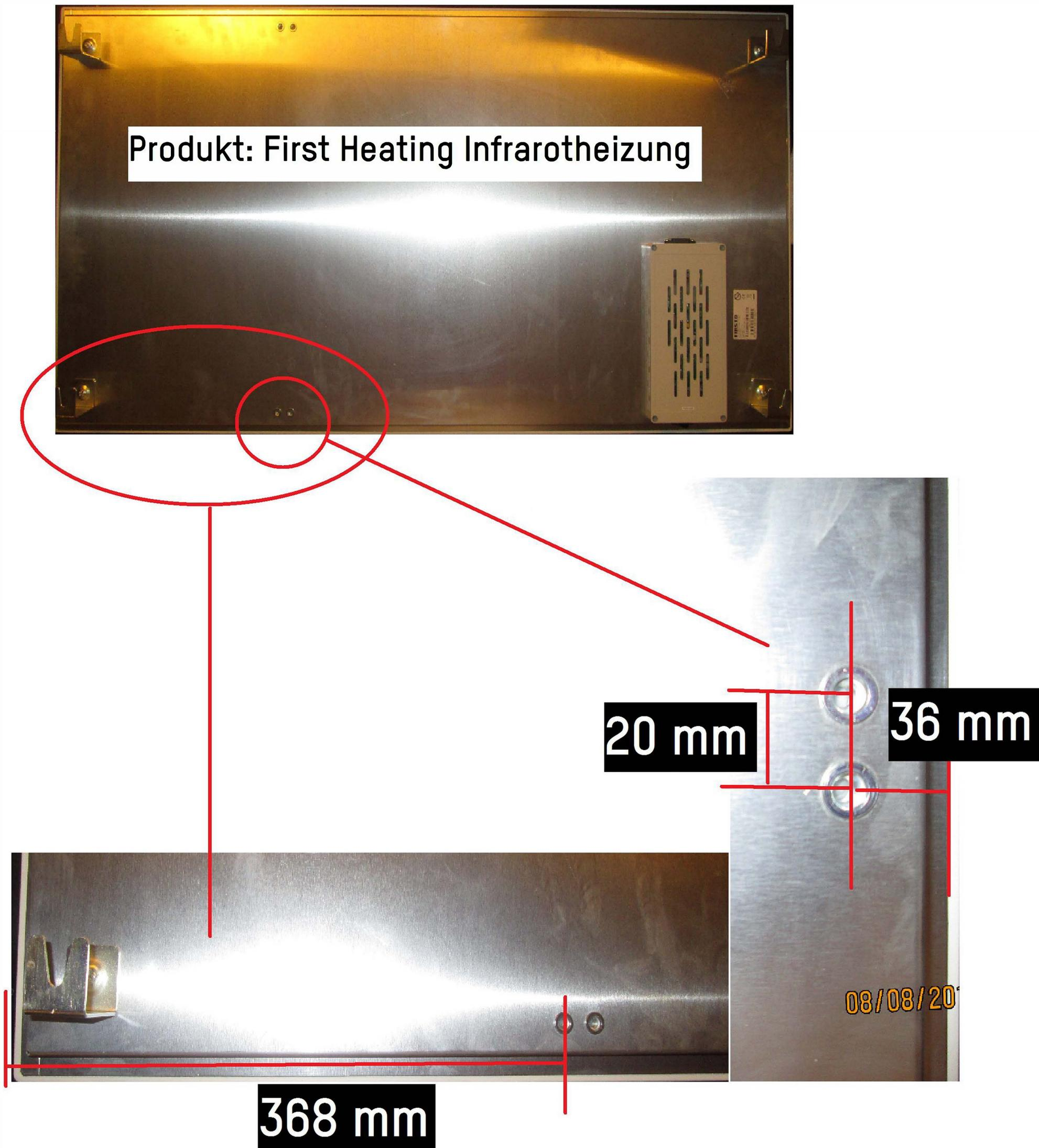
Wenn keine Gewinde vorhanden sind, können Blechschrauben verwendet werden: Max. 6x10 mm. Beim Vorbohren ist darauf zu achten nur die Rückwand zu durchbohren und nicht noch tiefer in Panel bohren.
