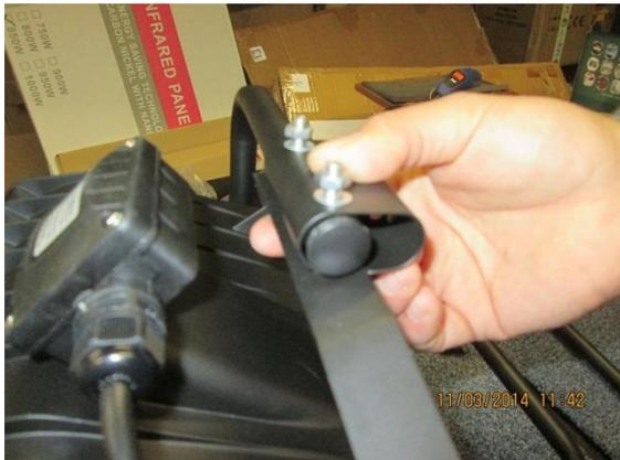
Hier sehen wir nun den Haltebügel mit der ovalen Führung unten am Strahler mit den beiden Schrauben, die durch alle Teile geführt sind.
