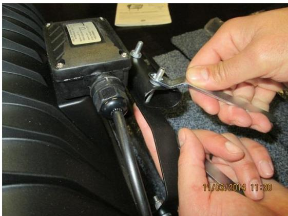
Lösen Sie nun als 1. die beiden hervorstehenden Schrauben am unteren Teil des Strahlers, um die ovale Führung zu entfernen.
