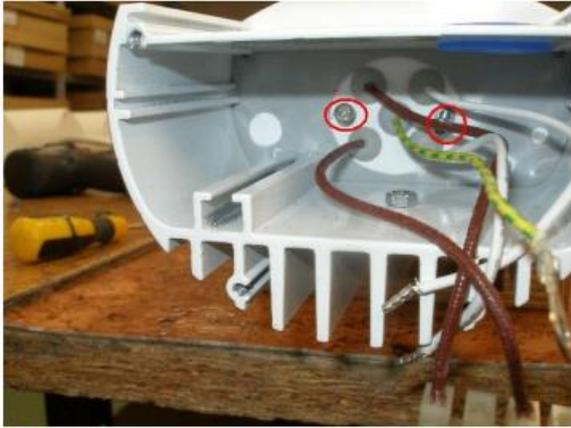
7. Dévisser les boulons de fixation du boîtier du BT.
