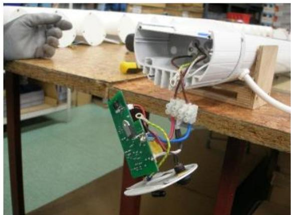
6. Éléments démontés du boîtier BT.
