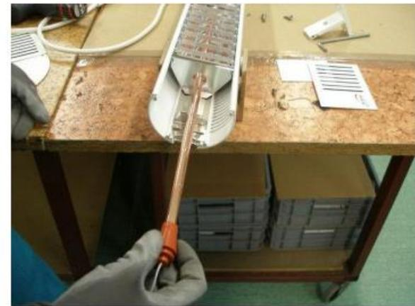
18. Démontez un émetteur d'un appareil de chauffage.
