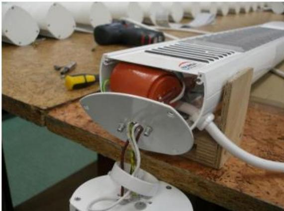
9. Dévisser l'élément latéral de l'appareil de chauffage.
