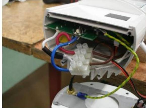
2. dévisser les fils de l'émetteur du cube de connexion électrique..
