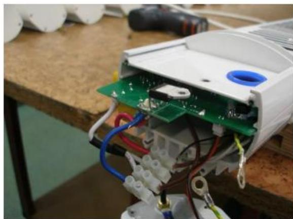
5. Demontieren Sie die BT-Platte.
