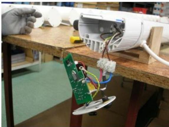
6. Demontierte die Elemente des BT Gehäuses.
