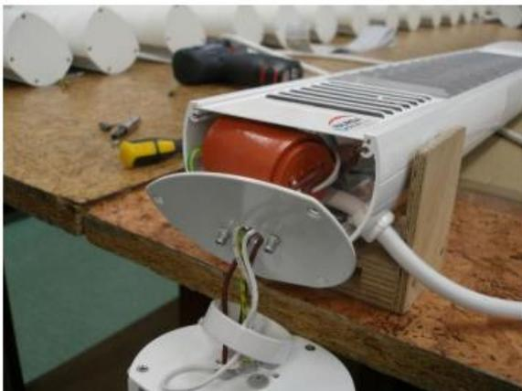
9. Schrauben Sie das Seitenteil des Heizgeräts ab.
