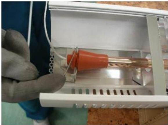
15. Demontieren Sie die Befestigungsfeder.
