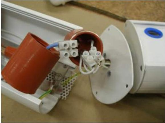
13. Demontieren Sie das Dichtungsrohr und schrauben Sie die Kabel des Strahlers ab.
