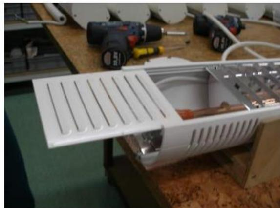
12. Demontieren Sie das zweite Frontelement.
