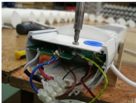
4. PE-Kabel demontieren.
