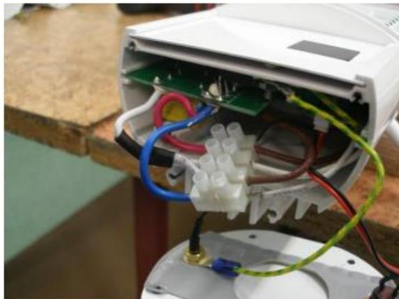
2. Schrauben Sie die Drähte des Strahlers vom elektrischen Anschlusswürfel.
