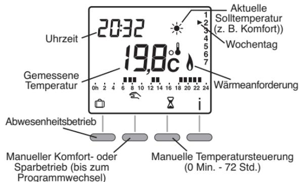
Bei Inbetriebnahme wird die vom Thermostat gemessene Temperatur angezeigt (das  $\downarrow$  Zeichen erscheint über  $^{\circ}\text{C}$ ).
